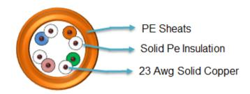
Conductor : Annealed Copper Conductor 24 AWG.
