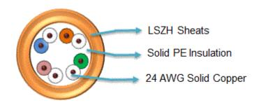
Conductor : Annealed Copper Conductor 24 AWG.
