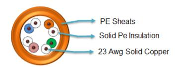
Conductor : Annealed Copper Conductor 24 AWG.
